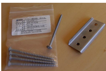
専用座金 (SUS 1.5mm厚) ・専用木ねじ (φ5.5×90mm ディスゴ処理)
