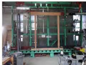
木造軸組単位フレーム（W1,820mm × H2,730mm）の実大実験
