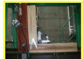
軽量鉄骨のフレームへ添木を用いて設置した事例（実大実験）
