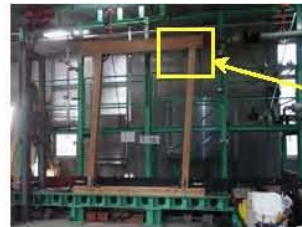
木造軸組単位フレーム（W1,820mm × H2,730mm）の実大実験
