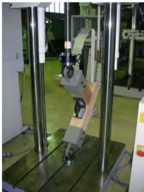
仕口単体の振動実験
